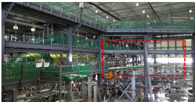
全機静強度試験 一部の試験実施模様 左:荷重負荷前 右:荷重負荷後
